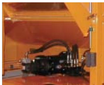
Pompe hydraulique fonctionnant sur l'hydraulique du camion
